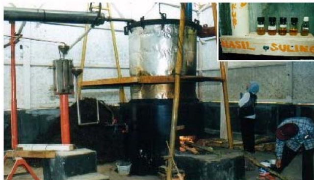
Model penyulingan minyak atsiri sistem kohobasi semiboiler dan contoh hasil sulungnya (inzet) yang dikembangkan pada kelompok tani di Desa Cikondang, Majalengka.
